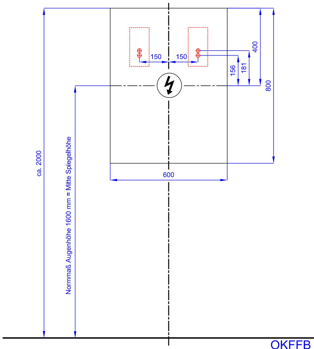
Maßangaben (ca. Werte in mm),  $\varnothing$  = Bohrloch 8 mm
