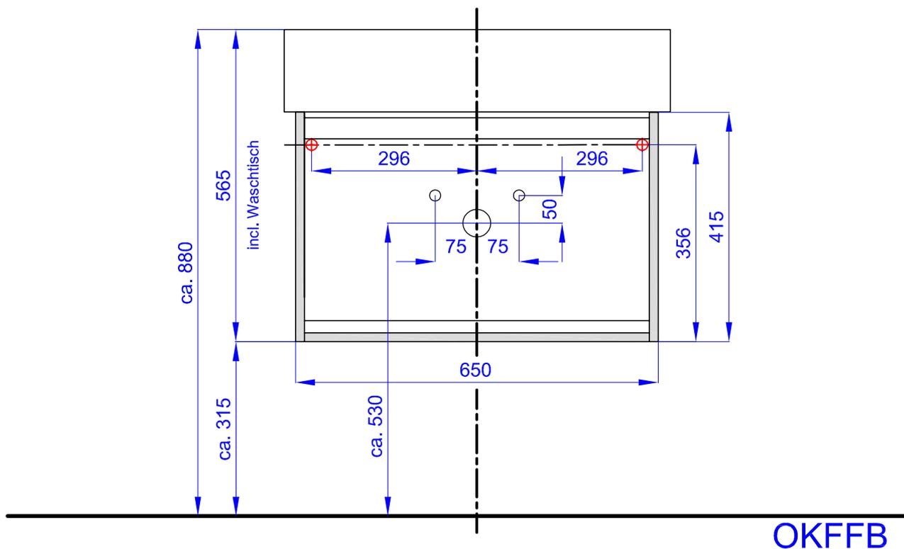
Maßangaben (ca. Werte in mm),  $\varnothing$  = Bohrloch 8 mm
