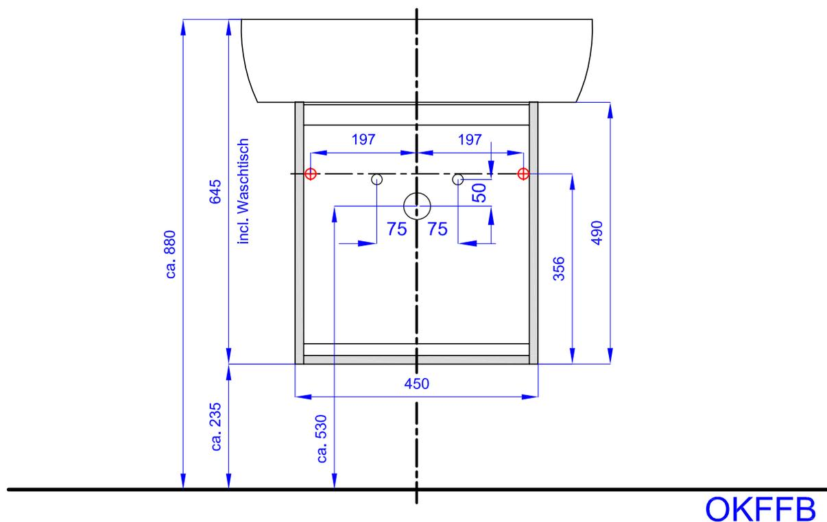
Maßangaben (ca. Werte in mm),  $\varnothing$  = Bohrloch 8 mm
